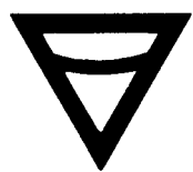
CAVO Trasversale alla corrente, estremamente pericoloso. Può essere il cavo di un traghetto, di una linea sotto tensione, di un carrello trasportatore, di una benna, ecc...
